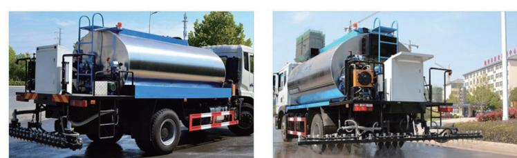
الأسفلت موزع يمكن استخدامها لنقل والرش السائل الأسفلت ) بما في ذلك الأسفلت الساخن ، مستحلب الأسفلت وبقايا النفط ( في بناء أو صيانة الأسفلت الرصيف أو بقايا النفط الرصيف باستخدام طريقة اختراق الأسفلت أو طبقات الأسفلت المعالجة السطحية. فائدة نموذج يمكن أن تستخدم أيضا في رصف الأسفلت وسادة رش في صيانة الطريق ، وبناء الطريق في المقاطعات والبلدات التي تعتمد على طبقات سطح الطريق التكنولوجيا.
